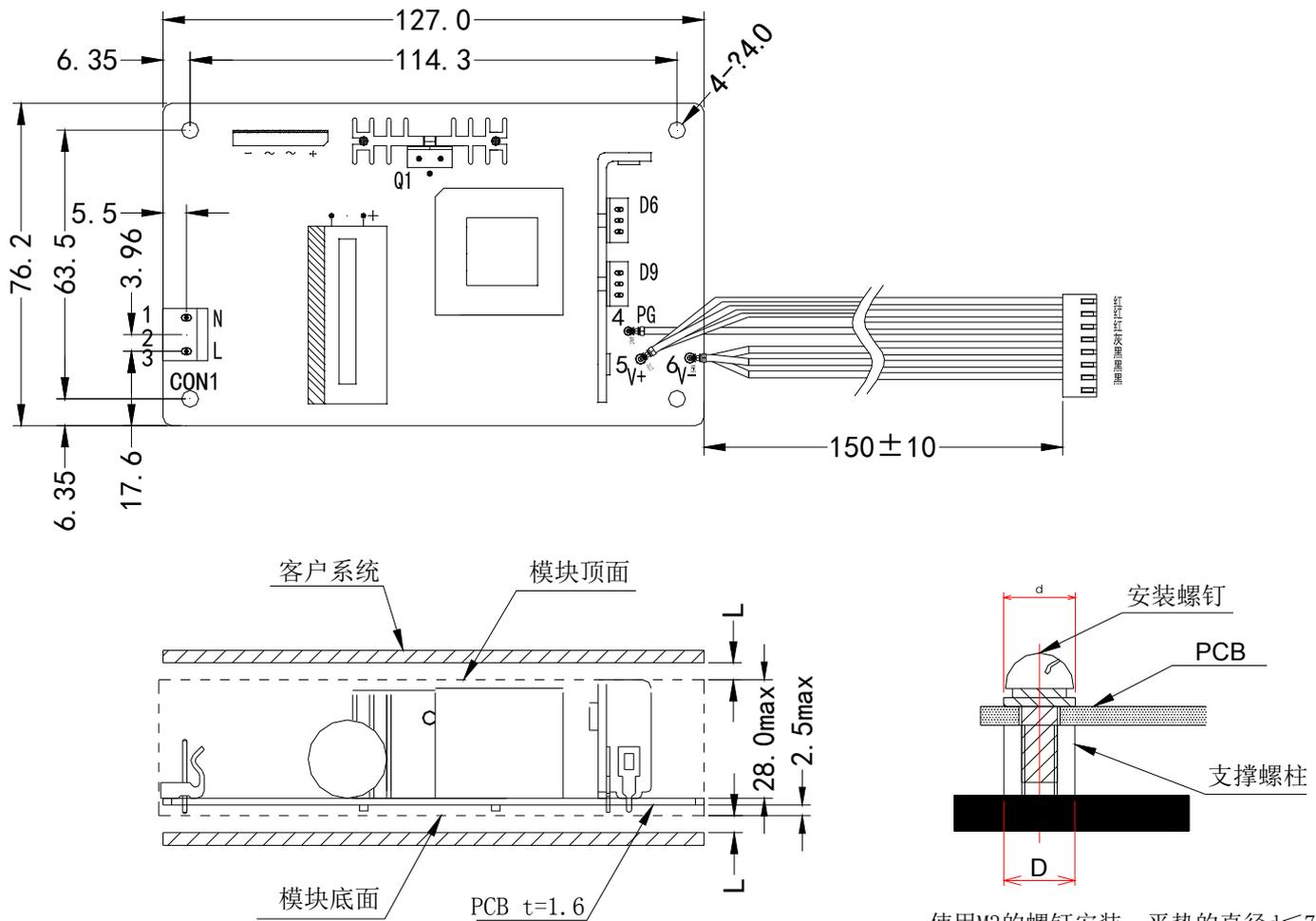
使用M3的螺钉安装，平垫的直径 $d \leq 7\text{mm}$
